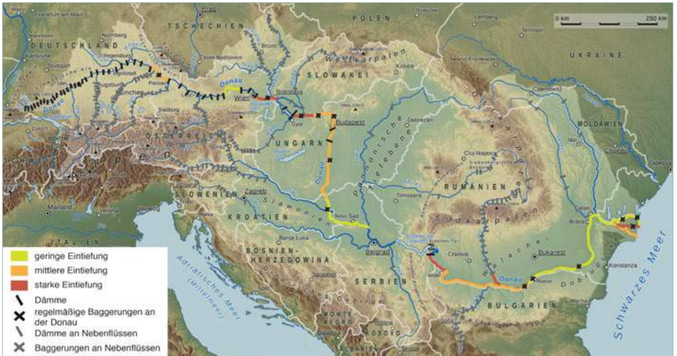
Sohleintiefung an der Donau
